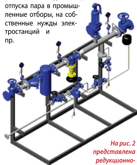
На рис. 1 представлена редуционная установка от Steam Expert с регулятором прямого действия производства «ARI-Armaturen».
